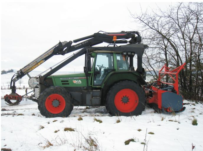
Forstschlepper - Fendt Vario mit Forstmulcher
